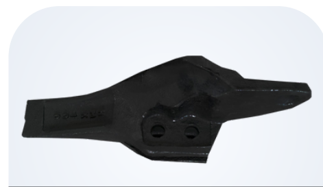
HIDROMEK 100 KAZMA UCU (SOL KÖŞE)
